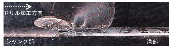
図6 切り屑詰りにより折損したドリル
